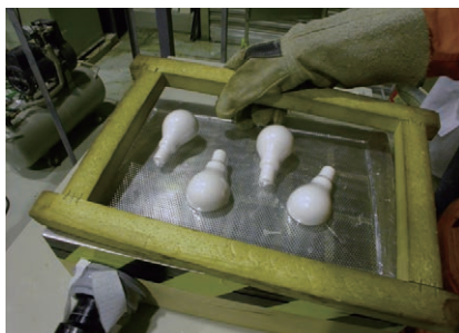
図2-4 真空成型による筐体生産
