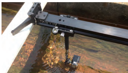
図5 移動撮影装置と水中のカメラ （撮影：櫻井 宏哉）
