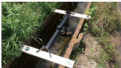
図4 移動撮影装置はスライダーと木材の支持体、水平に設営するためのアジャスターと水準器で構成（撮影：櫻井 宏哉）
