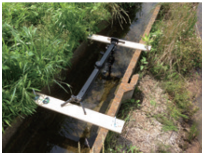
図6 移動撮影装置はスライダーと木材の支持体、水平に設営するためのアジャスターと水準器で構成（撮影：櫻井 宏哉）
