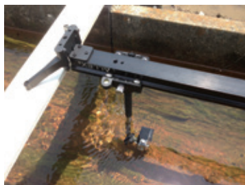
図6 移動撮影装置はスライダーと木材の支持体、水平に設営するためのアジャスターと水準器で構成 (撮影：櫻井 宏哉)
